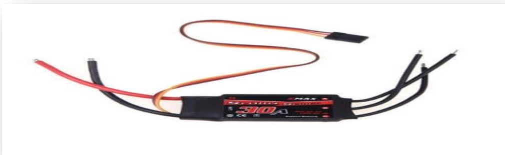
Figure IV.7: Contrôleur de Vitesse Électronique (ESC)
