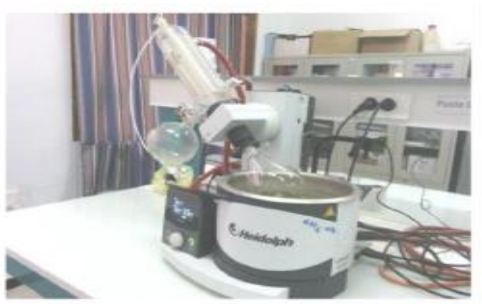
Annexe 19 : Photo de Rota vapeur (Heidolph)
