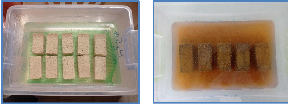
Figure (IV.22): Etat des échantillons après 28 jours d'immersion dans l'acide.
