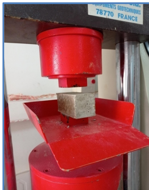
Figure (I.3) : Essai de la résistance à la compression.
