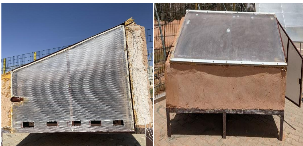
Figure III. 4. Prototypes de séchoir solaire de type direct
