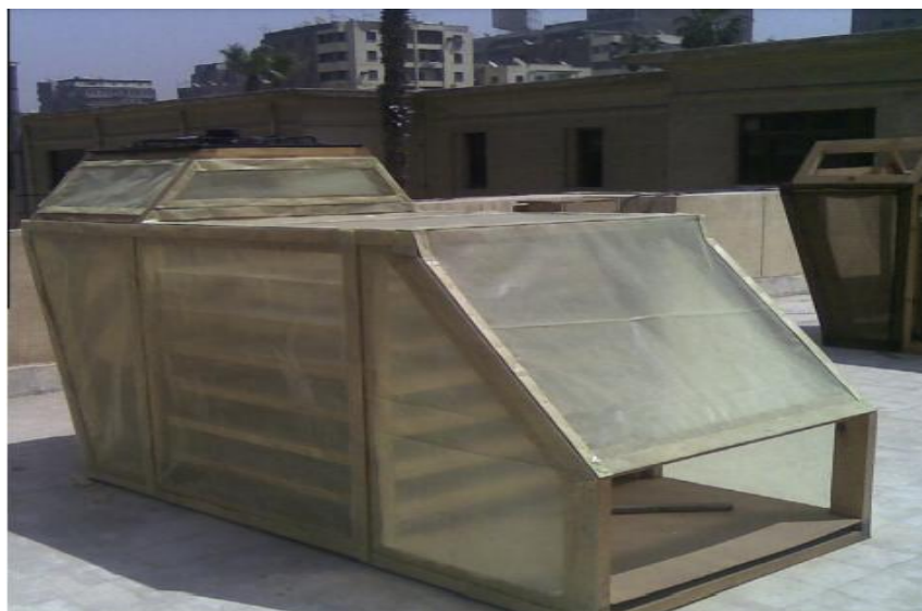
Figure II. 6. Photographie du séchoir solaire direct [63]
