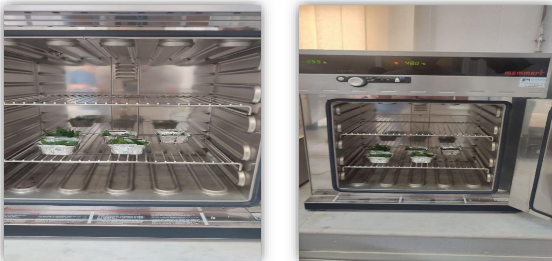
Figure III. 13. Photographies de l'étuve utilisée pour déterminer la teneur en matière sèche
