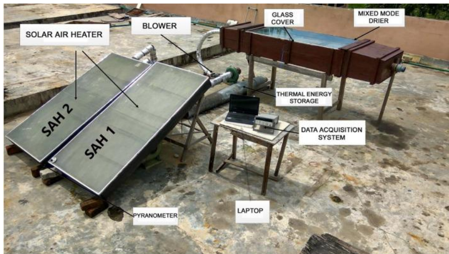
Figure II. 18. Vue photographique d'un séchoir solaire à convection forcée en mode mixte
