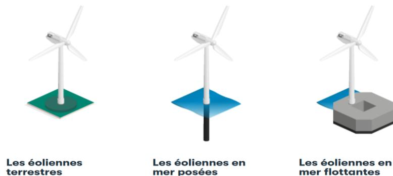
Figure 1.4 : Types des éoliennes.[5]
