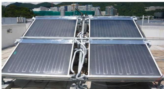
Figure 2.5 : Plateforme expérimentale du système hybride PV-SAHP/GHP. [39]
