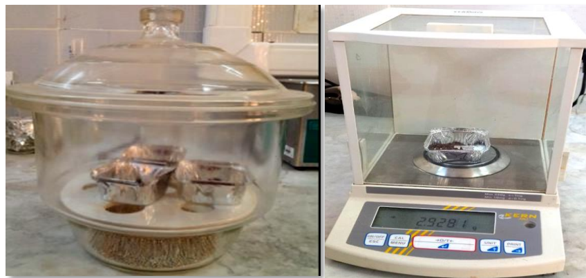
Figure. III.28. Pesée les trois échantillons de carotte séchés après refroidissement dans le dessiccateur.
