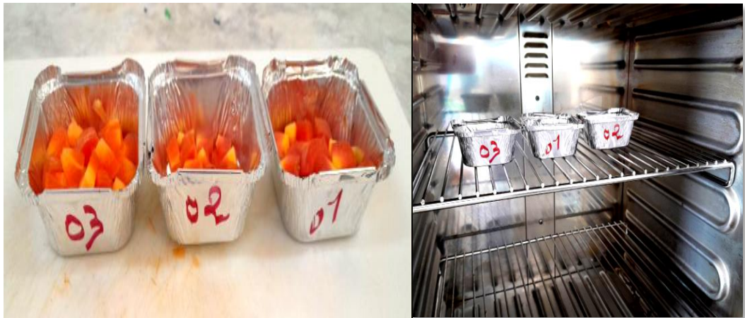
Figure. III.27. Trois échantillons de carotte dans une étuve à 105 °C pendant 24 heures.
