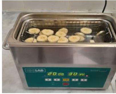
Figure. III.25. Traitement des tranches de pomme de terre par ultrasons ISOLAB.
