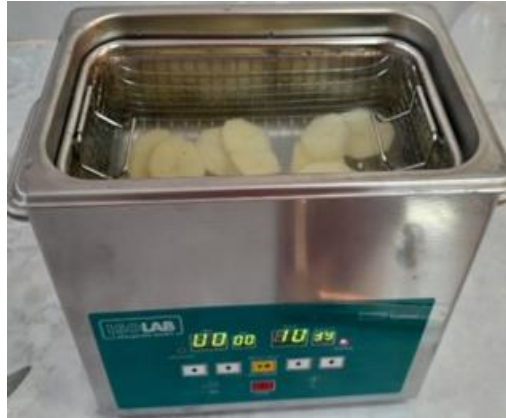
Figure. III.23. Traitement des tranches de pomme de terre par ultrasons ISOLAB.
