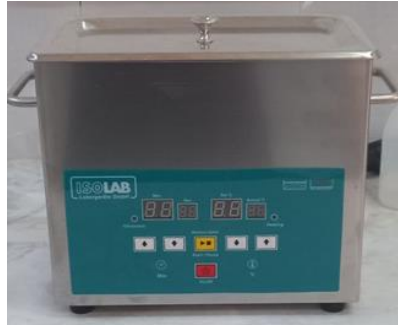
Figure.1. Bain à Ultrasons de laboratoire.
