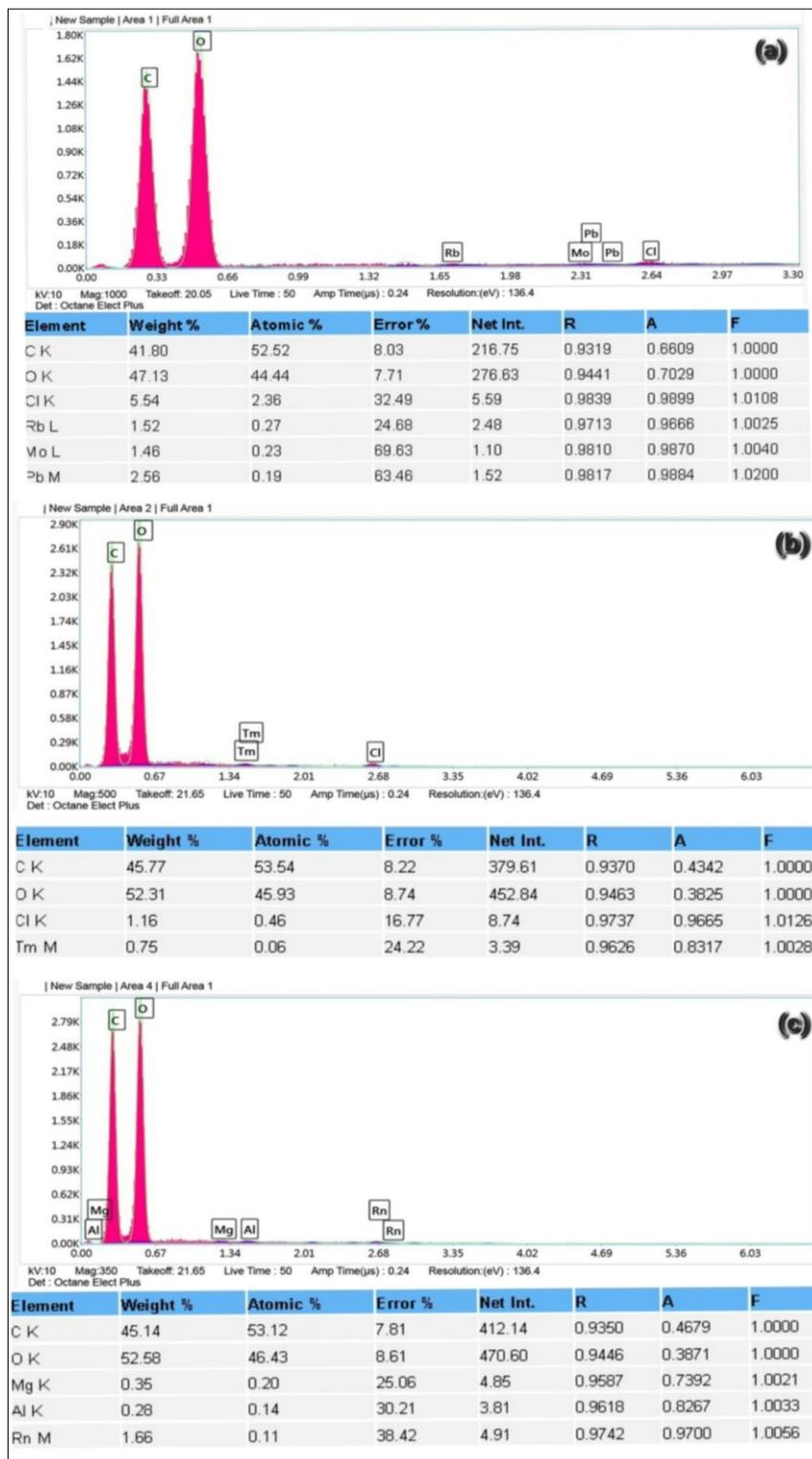
**Figure 10 :** Analyse spectrochimique par une sonde EDX (MEB-EDX) à des CNCs de palmier dattier isolées à partir de (a) *Lif*, (b) *Cornefet*(c) *Jrid*.
