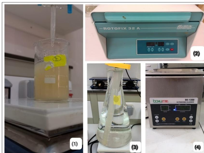
**Photographie 5 :** Photographies des étapes clés et instrumentation dans la préparation des CNCs : (1) L'hydrolyse à l'acide sulfurique, (2) Centrifugation, (3) Dialyse et (4) L'ultrasonication.
