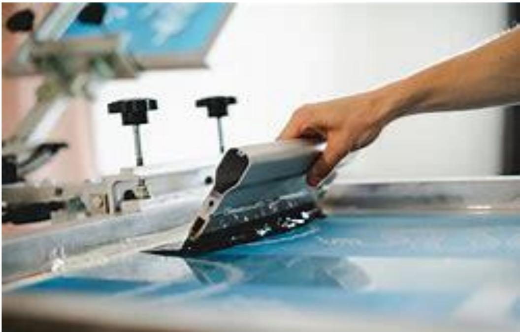
Figure 1.1:machine l'impression sérigraphie [29]
