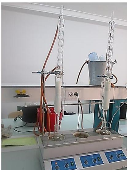
**Photo 7:** Montage d'extraction par solvant (Extracteur soxhlet) ( Originale).
