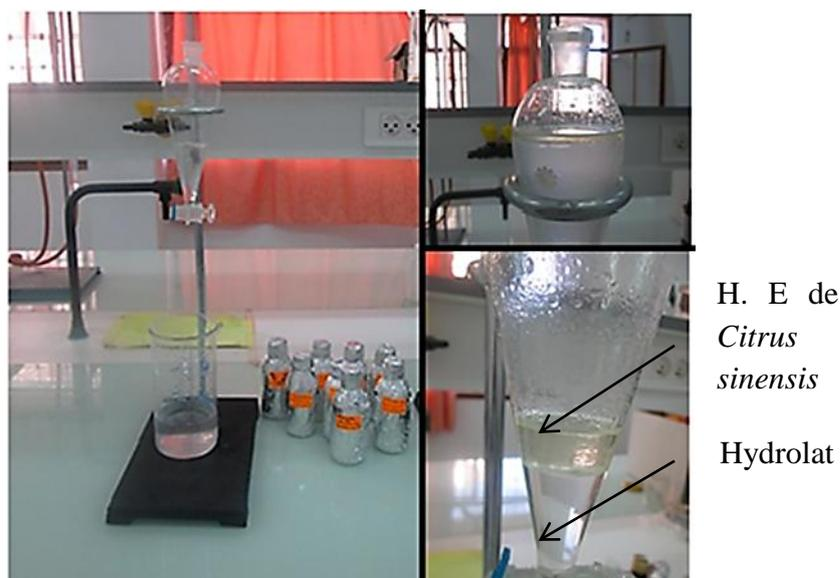
**Figure 13** : Séparation d'huile essentielle par l'ampoule de décantation (Originale).
