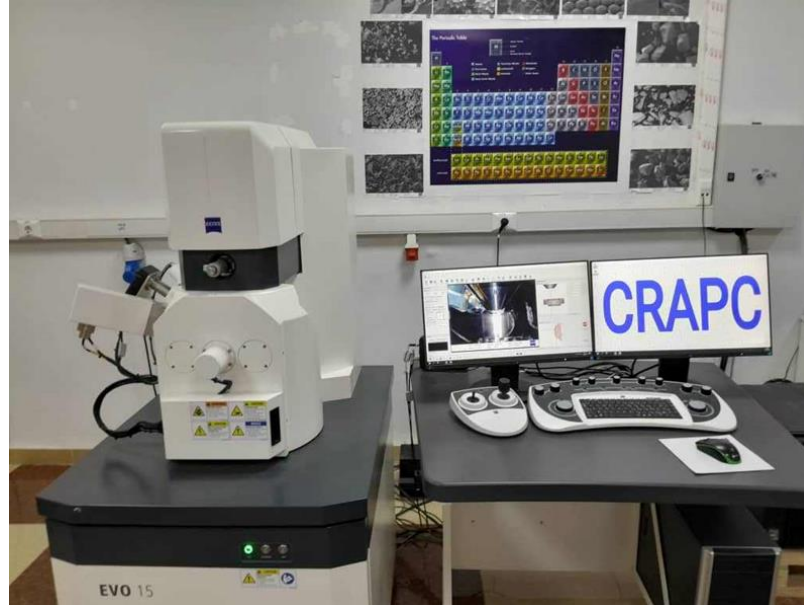
Annexe 11 : MEB (Marque SEM.EVO 15 ZEISS)
