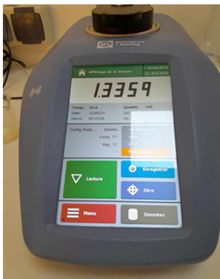
Annexe 06 : Refractomètre (Marque BS ; Bellingham+ Stanley)
