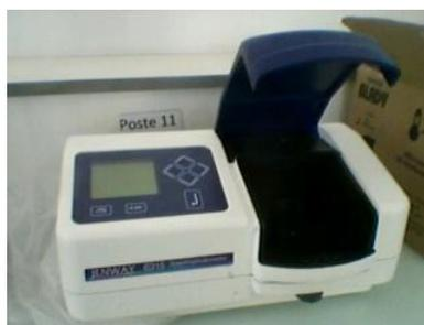
**Photo E:** Détermination des absorbances avec le spectrophotomètre (ORIGINALE, 2013).
