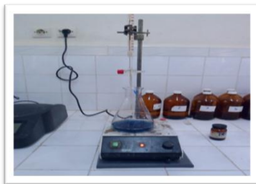
Figure III.7 : dosage du calcium
