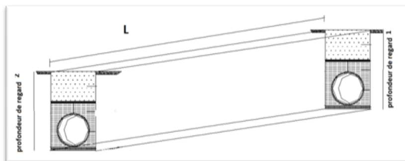
Figure 22.tranço entre deux regards
