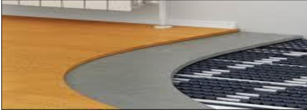
**Figure I.15.** La chape d'un plancher chauffant.
