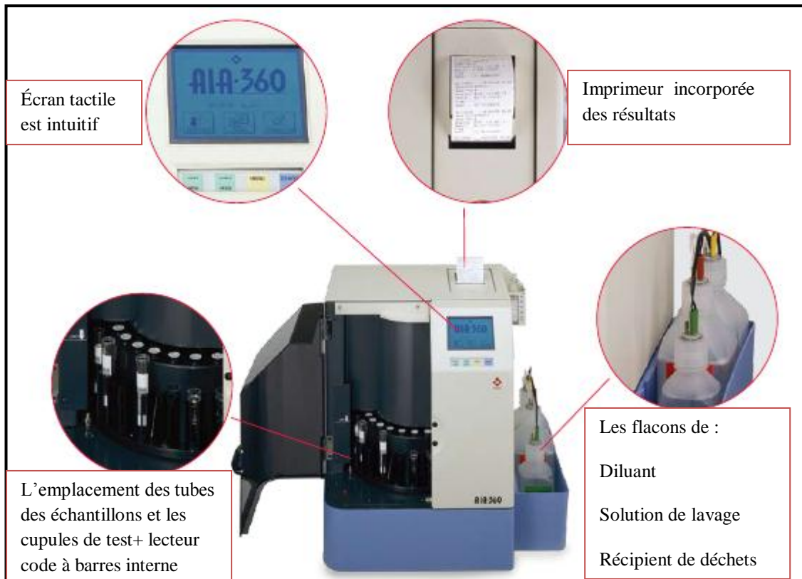
Figure n° 09 : Les compositions de TOSOH bioscience AIA 360 (site web 6)
