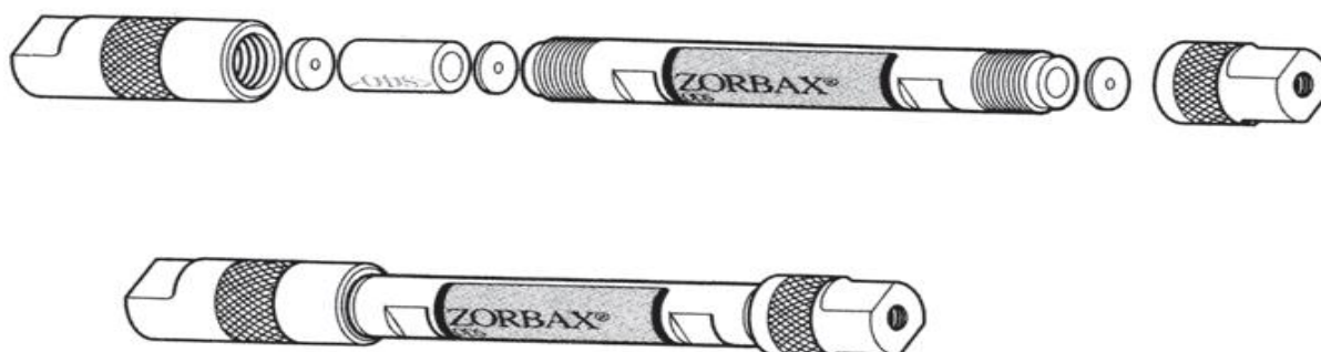
Fig. III.3: Colonne standard et précolonne de HPLC.
