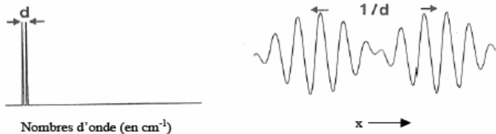
Figure 14 : Deux signaux spectraux espacés de d (gauche) et leur interférogramme (droite).
