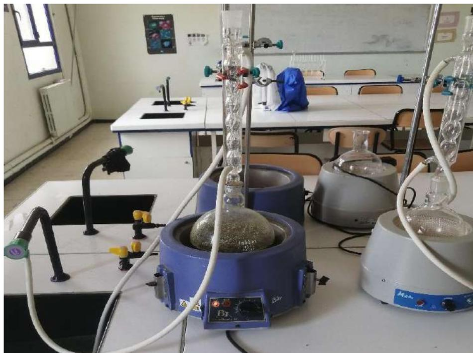
Photo 08.-Dispositif d'extraction des principes actifs par reflux (Originale, 2020).
