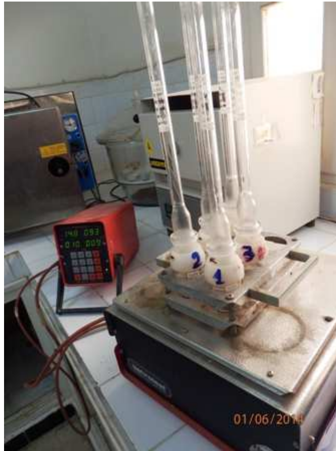
Fig- 10 : Réacteurs DCO « Laboratoire d'Algérienne des eaux »
