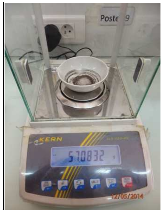
Fig- 06 : Creuset en platine contenant les résidus sec
