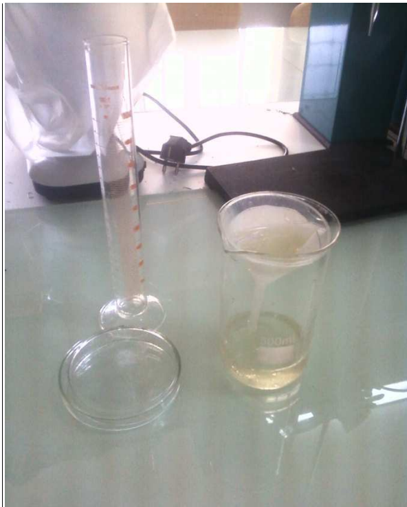
Fig- 07 : filtration de 100 ml d'eau
