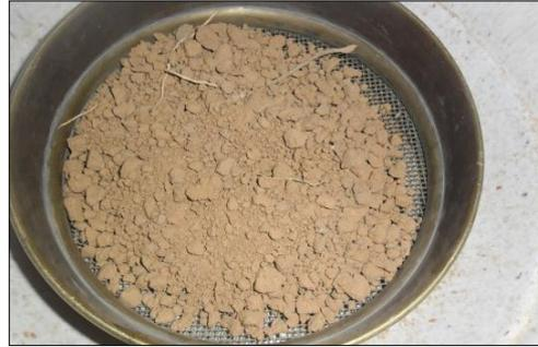
**Figure 17** : Tamisage des échantillons.
