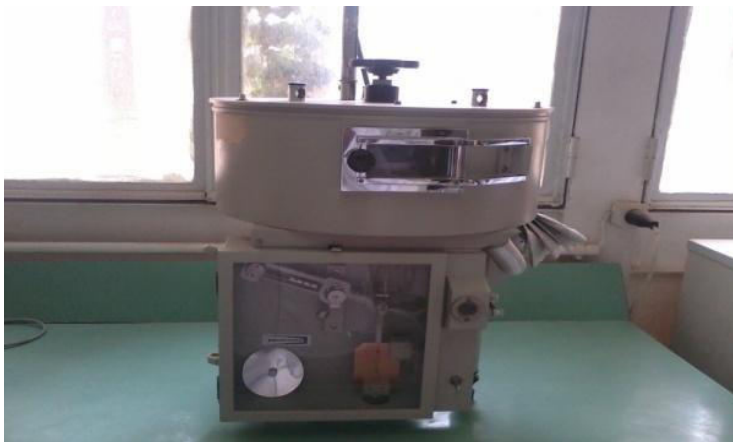
Figure N°5 : Appareil mesure de l'humidité
