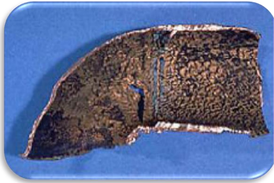
Figure N°11: Corrosion érosion d'un tube en cuivre véhiculant de l'eau [29].
