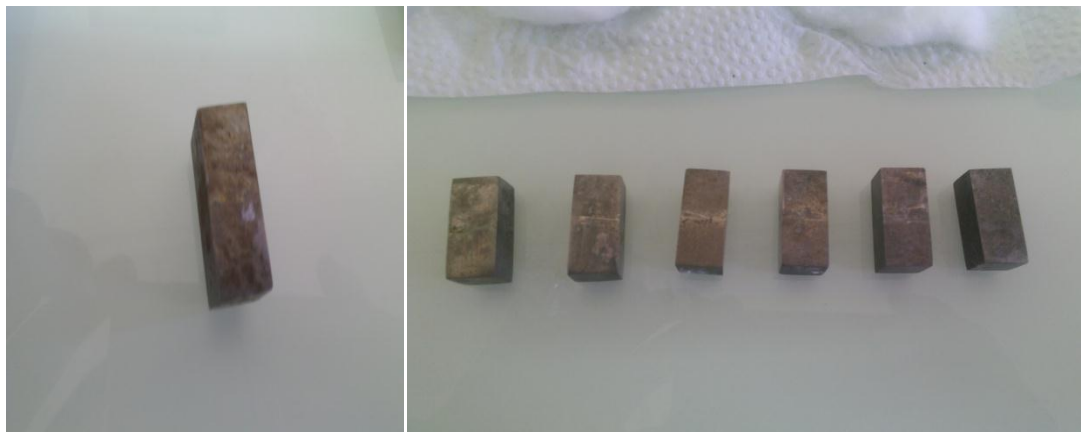
Figure N°20 : L'échantillon sans et avec l'inhibiteur (après 30min d'immersion).
