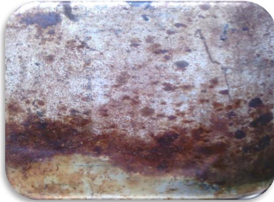
Figure N°9 : Corrosion par piqûres [27].
