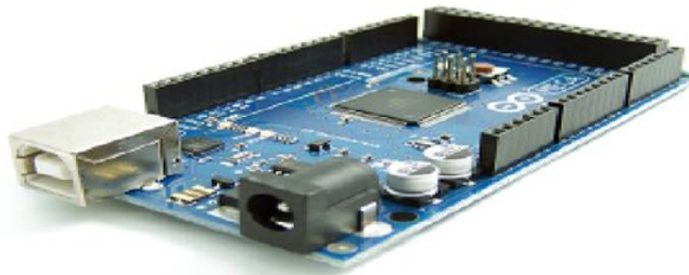
Figure III. 16: Carte Arduino Méga
