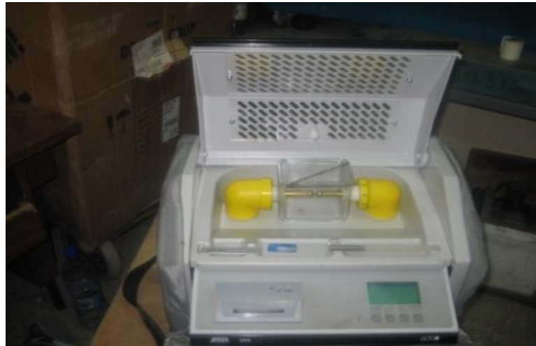
Figure III.7 : Schéma de la cellule de mesure de la tension de claquage [36]
