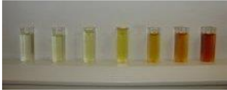
Figure II.6 : Changement de couleur des liquides isolants durant le vieillissement [26]
