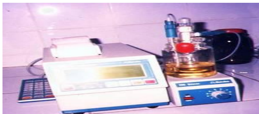
Figure III.3: Titreur Karl Fisher pour la mesure de la teneur en eau de liquide isolant [36]
