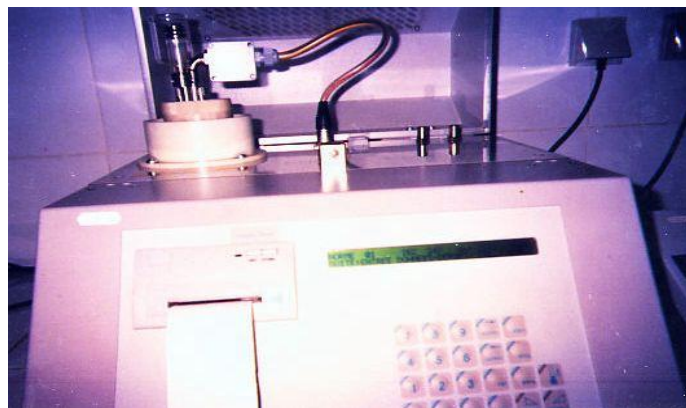
Figure III.9 : Dieltest DLT utilisé dans la mesure du facteur de dissipation diélectrique et la permittivité relative [36]
