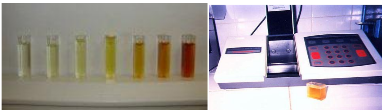
Figure III.8 : Dégradation de liquide isolant au cours de vieillissement thermique (changement de couleur), photographie de colorimètre pour la mesure de l'indice couleur [35 ,36]
