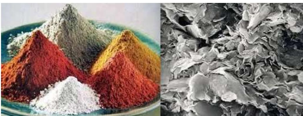
Figure II.2 : argile à différents couleur / Vue au microscope électronique d'une argile verte.
