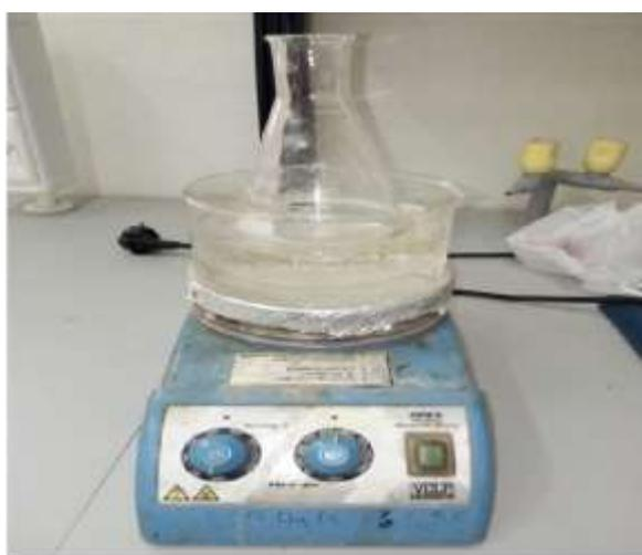
Photo14 :plaque chauffante munie d'un agitateur
