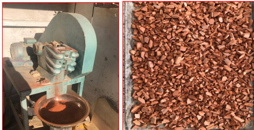
Figure II.8. La machine de concasseur des briques LTPS.
