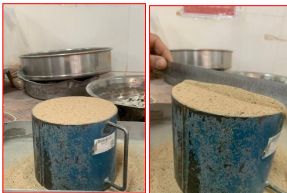
Figure II.6. Détermination de la masse volumique apparente.
