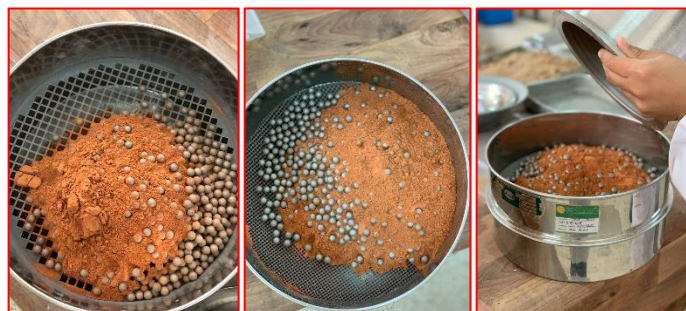
Figure II.10. Tamisage manuellement de la poudre et granulés des briques.
