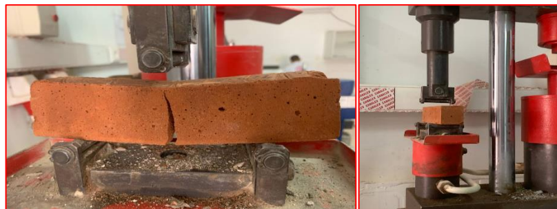
Figure II. 18. Dispositif de l'essai mécanique de rupture par flexion.
