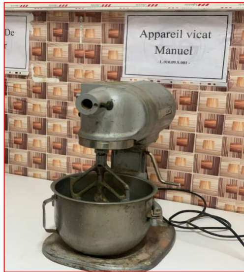
Figure II. 13. Malaxeur électrique utilisée dans la fabrication du mortier [Labo Béton – LTPS].
