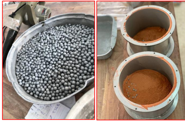
Figure II.9.a. Granulés de brique dans le Moule de la machine de Micro Duval avec granulés de fer.
