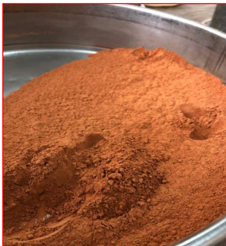
Figure II.11. La poudre finale de brique qui est passée sur le tamis 0.08 mm.
