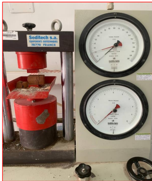
Figure II. 17. Dispositif de l'essai mécanique de Compression.
