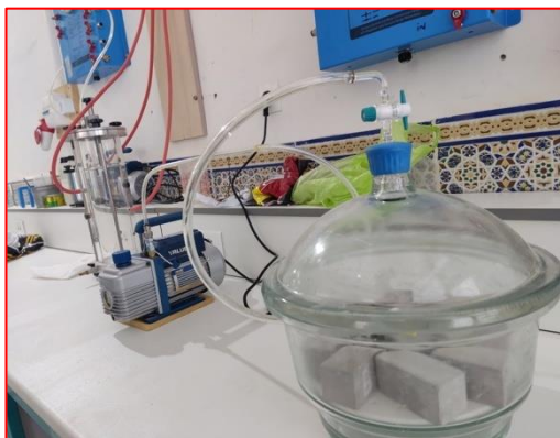
Figure II.19. Montage pour la mesure de la porosité accessible à l'eau.
