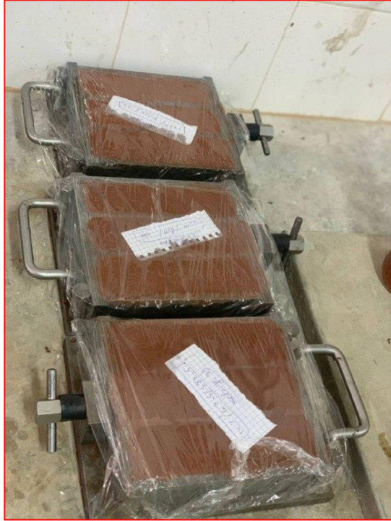
Figure II. 15. Le moules sont prêts et remplis.
