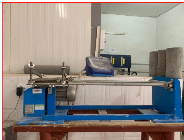
Figure II. 14. l'appareille à choc [Labo Béton –LTPS].
