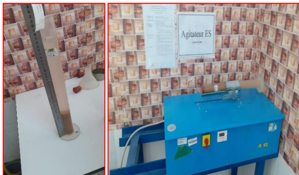
Figure II.5. L'essai au piston de l'équivalent de sable.
