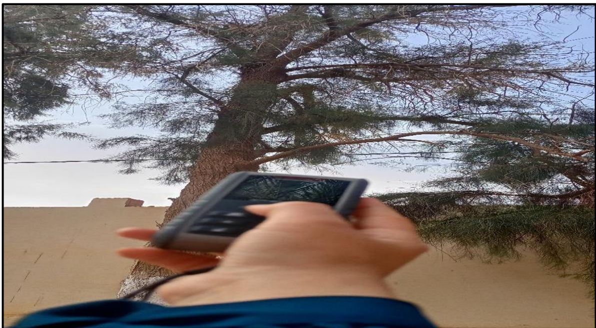
Figure09 : Mesures de la hauteur HNS avec le télémètre (Originales, 2023)
