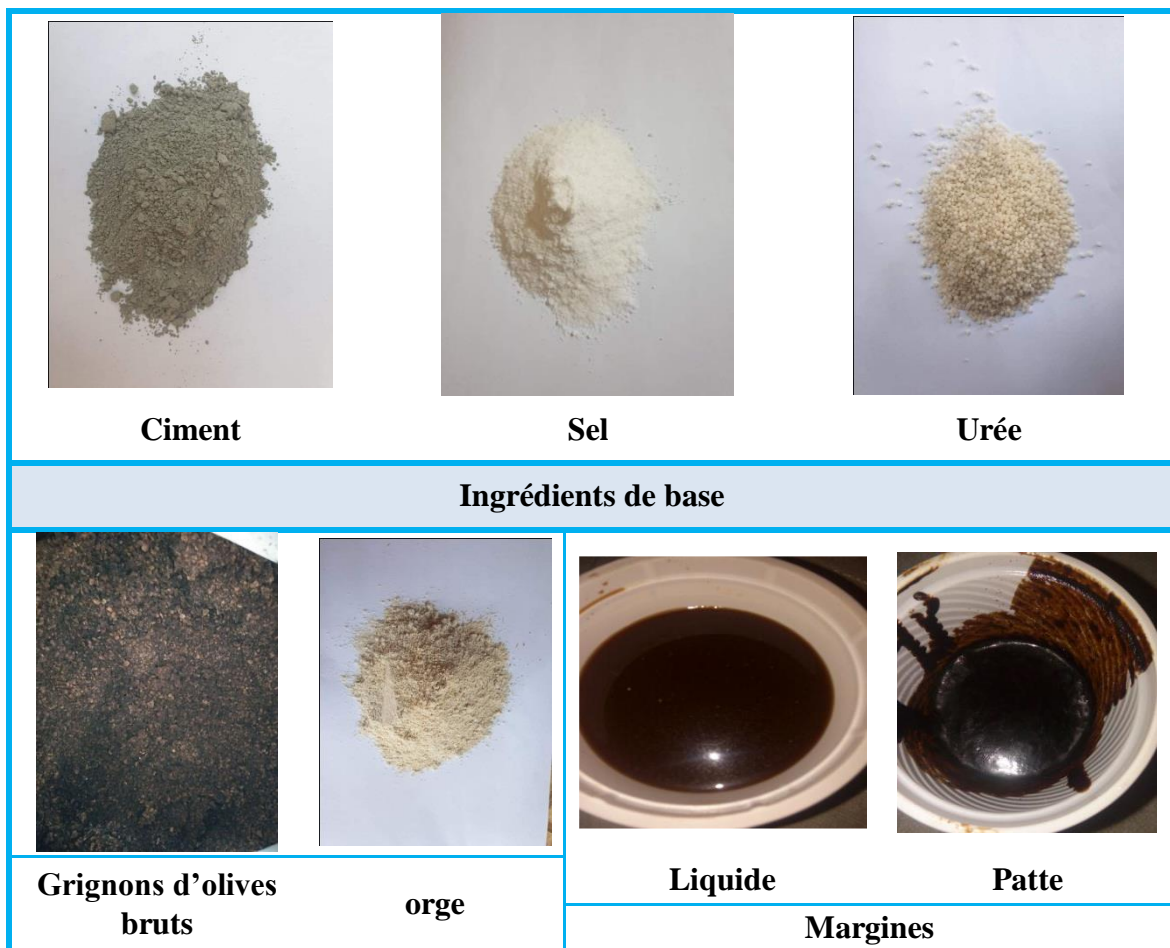
Figure 07: Ingrédients utilisés pour la fabrication des blocs (Origine)
