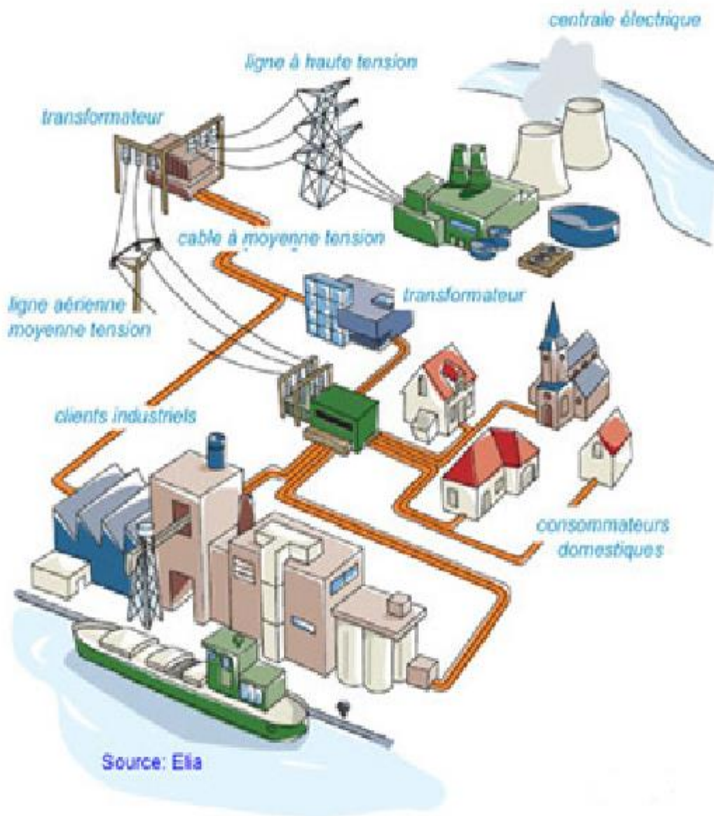
Figure II.1 : Structure générale d'un réseau électrique.
