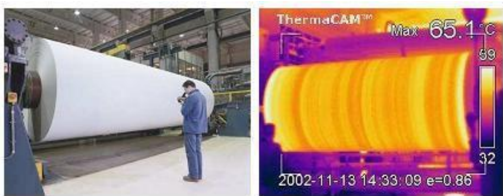
Figure III.7 : Image visible et thermogramme correspondant d'un rouleau de papier
