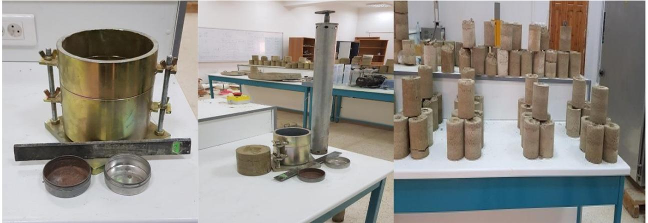
Figure 14 : Mode opératoire de Proctor (mehrez khemakhem)
