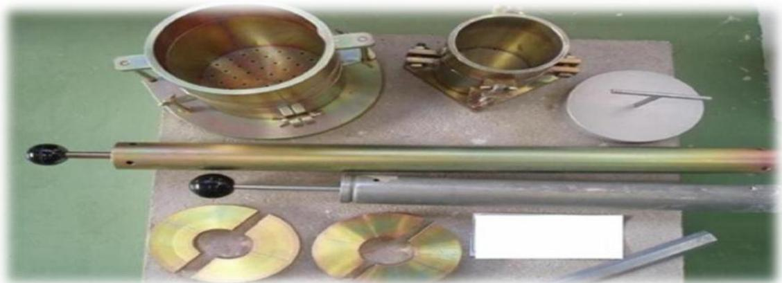
**Figure 13** : l'appareille de l'essai au Proctor modifié (zemouri 2020)
