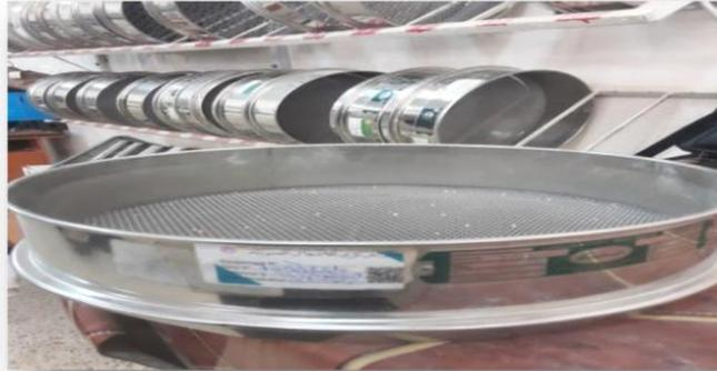
**Photo 08 :** Tamis de 2mm pour cribler l'échantillons (source auteur)
