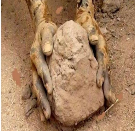
الشكل 1.1: طريقة تشكيل الطوب باليد. المصدر: محبوبي 2017
