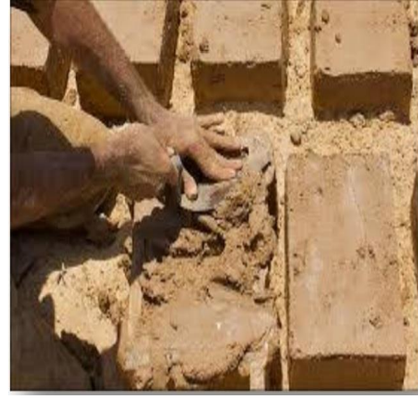
الشكل 1.1: طريقة تشكيل الطوب باليد. المصدر: محبوبي 2017
