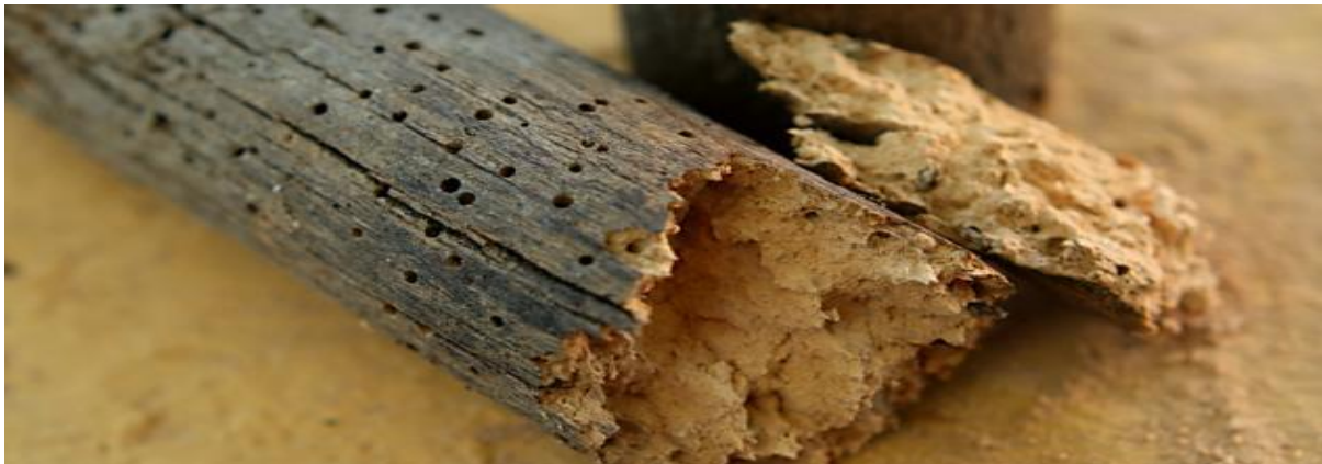
الشكل 7.2: توضح ظاهرة التسوس في الخشب.
