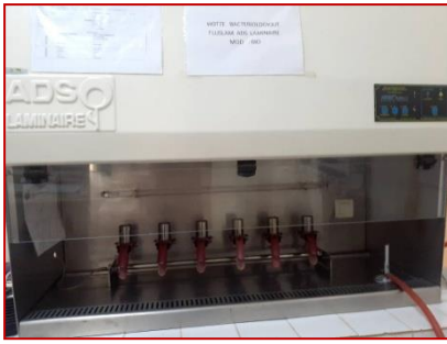
La rampe de filtration
