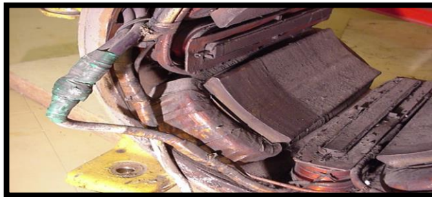
Figure (I.4) : L'inducteur à enroulements et pièces polaires (bobinée) [3]
