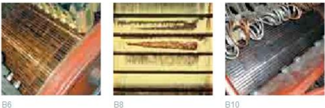
Figure (II.4) : Défauts brûlures collecteurs [16]
