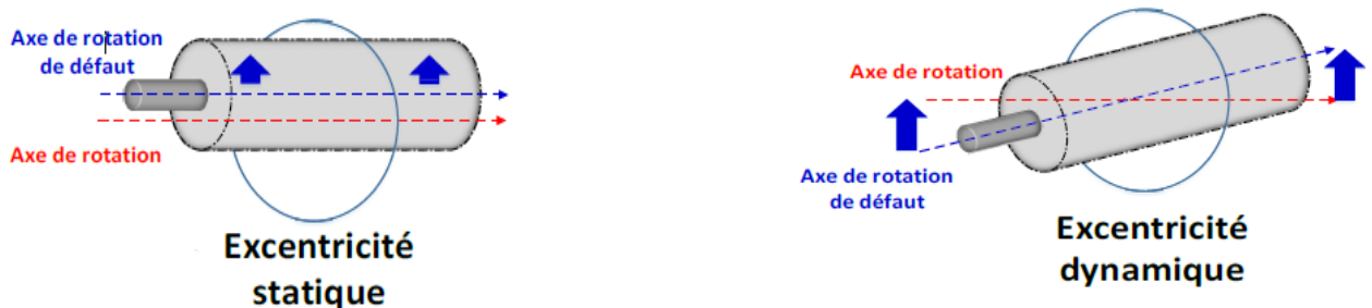
Figure I.7 Représentation de l'excentricité statique et dynamique
