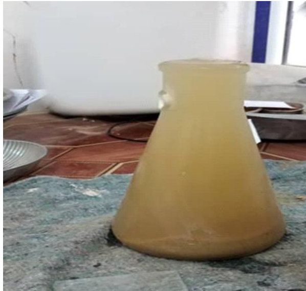
(Figure III.5) : récipient rempli par l'agrégat et l'eau
