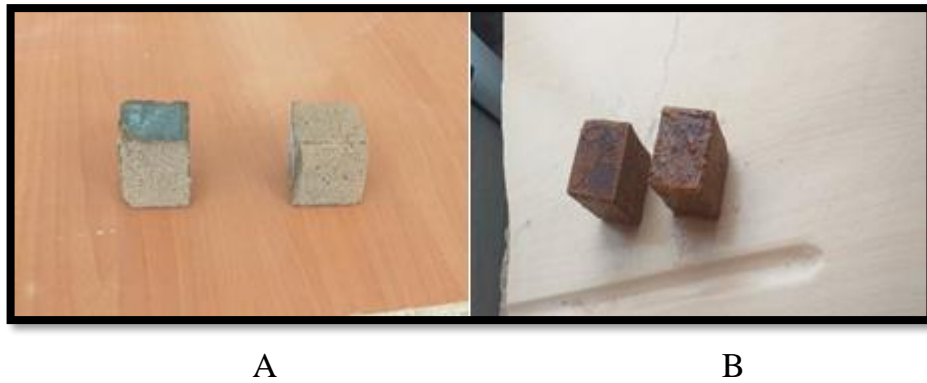
(Figure II.10) : échantillons du MAP après l'immerge dans la solution acide
