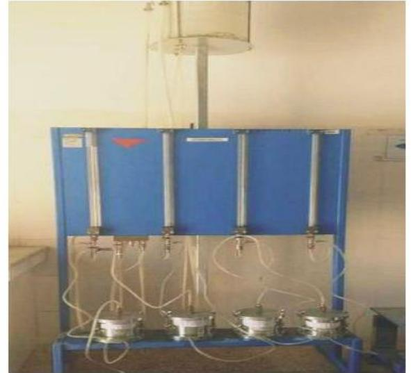
**Figure III-8** : Essai de perméabilité à charge variable.
