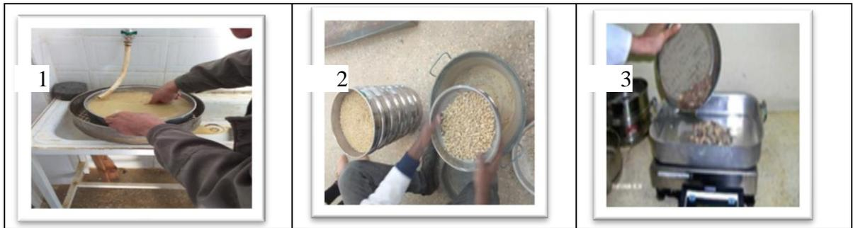
**Photos II-3** : les étapes de l'essai analyse granulométrique par tamisage
