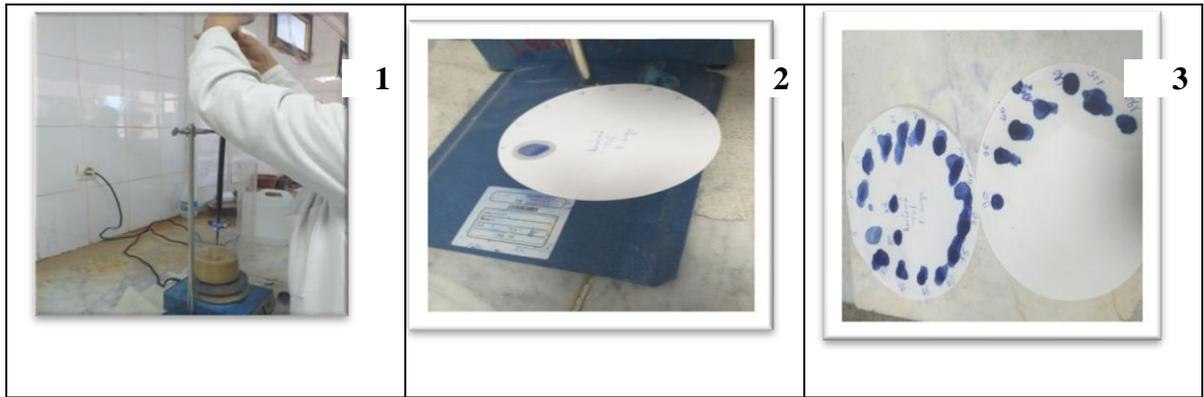
**Photos II-9** : Les étapes d'essai au bleu de méthylène
