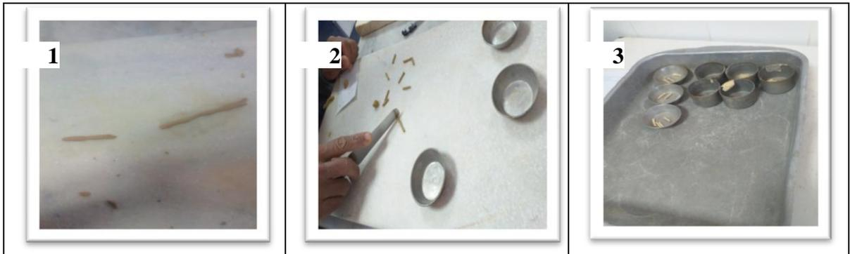
**Photos II-7** : les étapes d'essai Limite de plasticité
