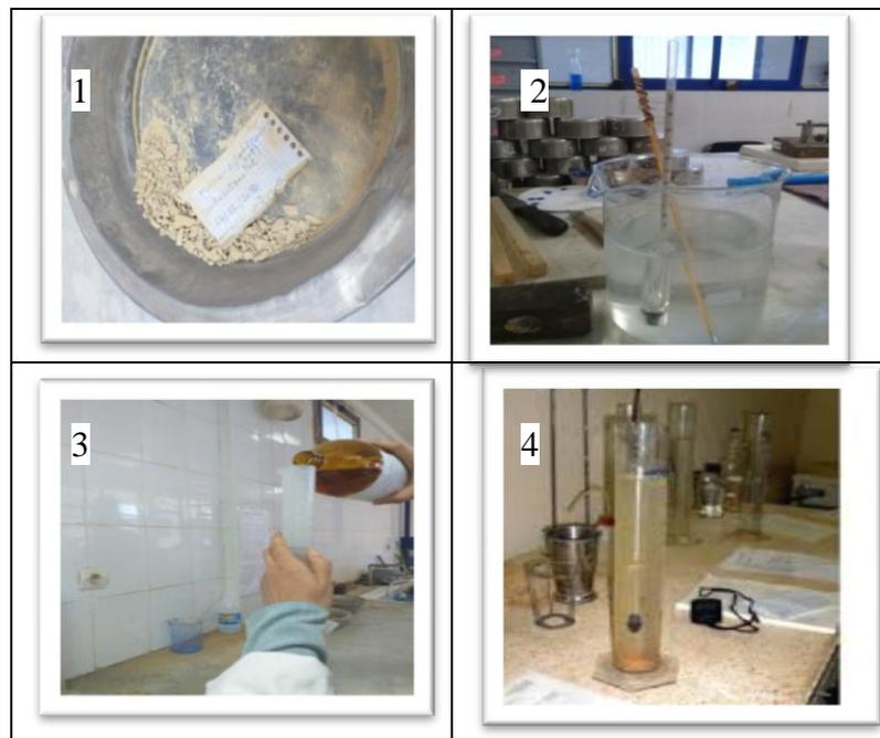
**Photos II-4** : les étapes de l'essai analyse granulométrique par sédimentométrie
