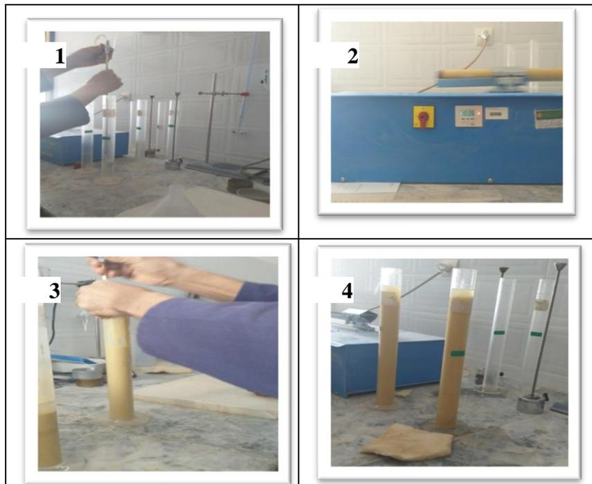
**Photos II-8** : Les étapes d'essai équivalent de sable
