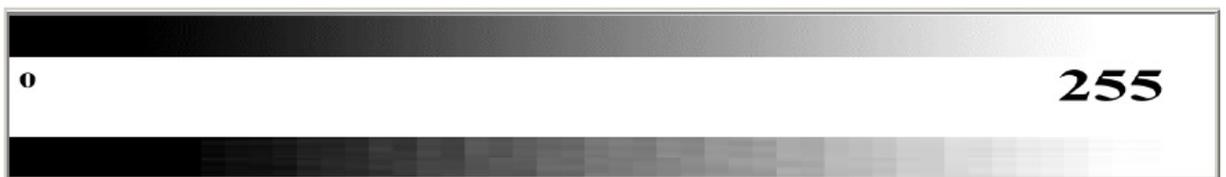
Figure (II.5): Quantification des niveaux de gris : passage d'une suite continue de valeurs à un ensemble discret de N valeurs.
