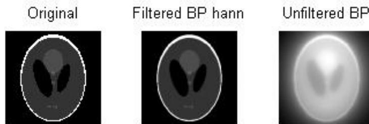
Figure (IV.11): Filtrage avec le filtre de HANNING
