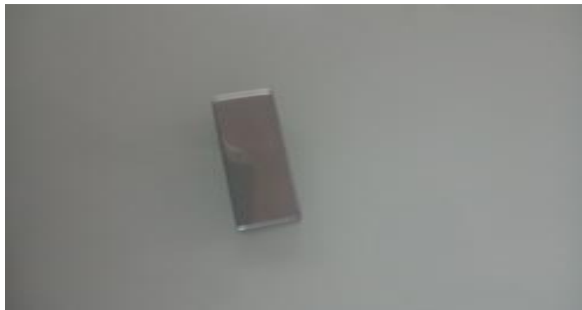
Figure N°IV-2 : Echantillon de l'acier X70 après le polissage.
