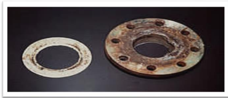
Figure N°I-6: Corrosion cavernuse d'un acier allié sous un joint
