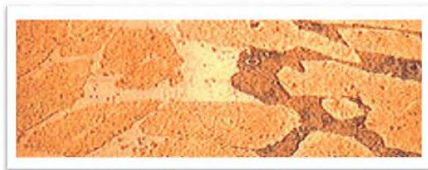
Figure N°I-7: Coupe métallographique Montrant une corrosion sélective d'un laiton
