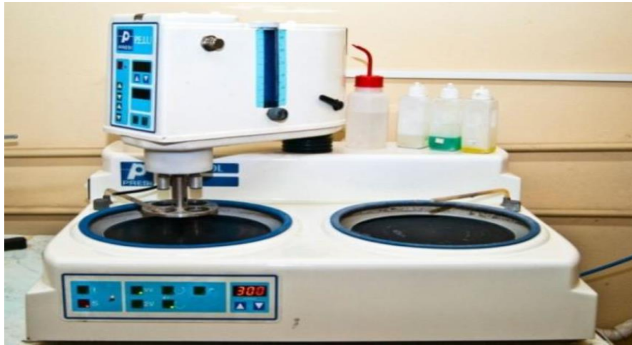
Figure N°IV-1: Appareil de polissage
