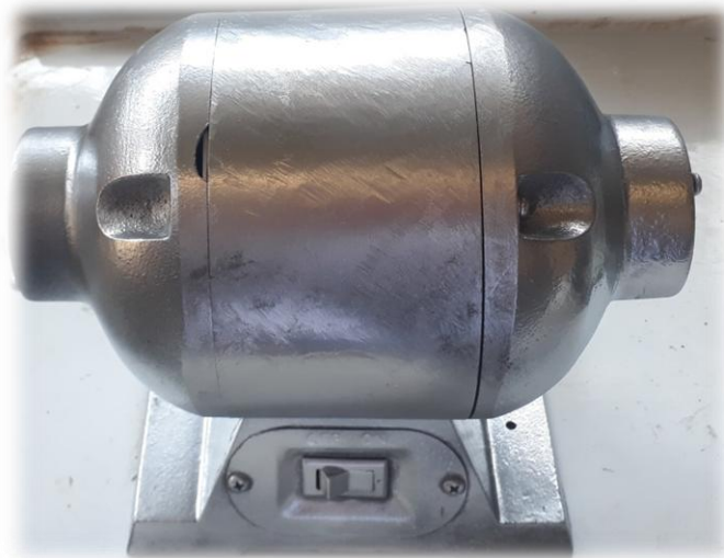
Figure 4 7 La génératrice (à aiment permanent)
