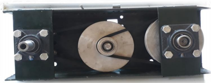
Figure 4 3 Le multiplicateur de vitesse
