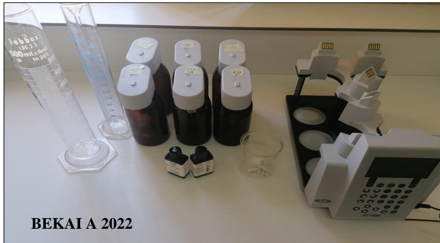
Figure 8 : Le DBO mètre utilisé dans la station (BD600)
