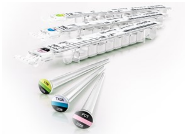
Figure 7 : Les cartouches de test d'immunochimie et hormonale [14].
