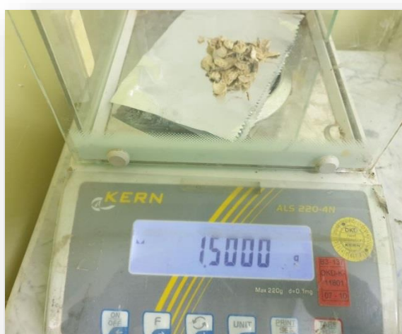
Figure 56: la masse de CA utilisée.
