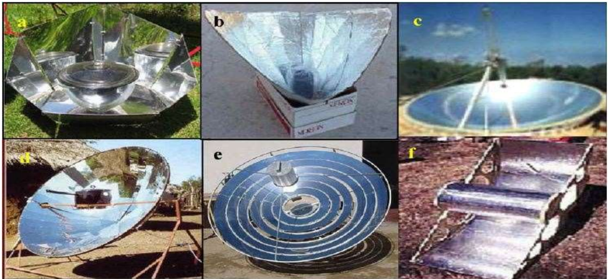
Figure II.11: Cuiseurs à concentration : (a) cuiseur a panneaux, (b) cuiseur entonnoir, (c) réflecteur sphérique, (d) réflecteur parabolique, (e) concentrateur Fresnel, et (f) concentrateur cylindro- parabolique.
