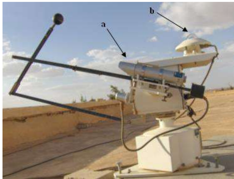
Figure I.2: Instruments de mesure du rayonnement solaire.(a):Pyrhéliomètre (mesure du rayonnement direct normal),(b): Pyranomètre (mesure du rayonnement global et diffus). (Photo de l'Unité de Recherche Appliquée en Energies Renouvelables – URAER, Ghardaïa)
