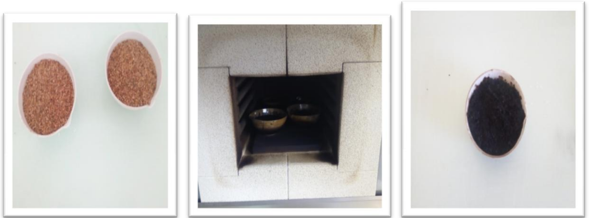
Figure II-12 : Méthode de la fabrication du noir du carbone à partir les noyaux des dattes dans un four électrique [L.Afifa.université Ghardaïa]
