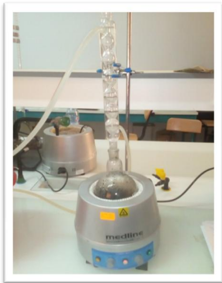
Figure II-15: de Montage de l'activation
