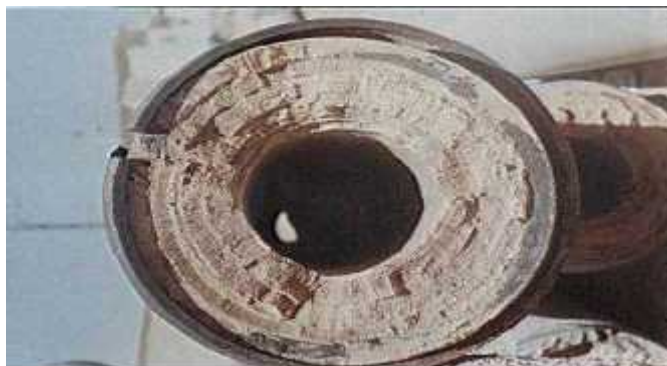
Figure N°8 : Entartrage des conduites de distribution en amiante ciment (BOUTAOUTOU et ZEGGANE, 2011)
