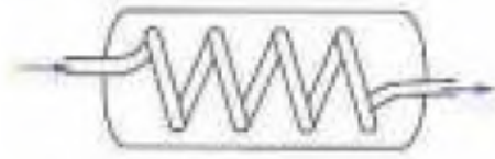
Figure (I-3) : Echangeur monotube en serpentin [13]
