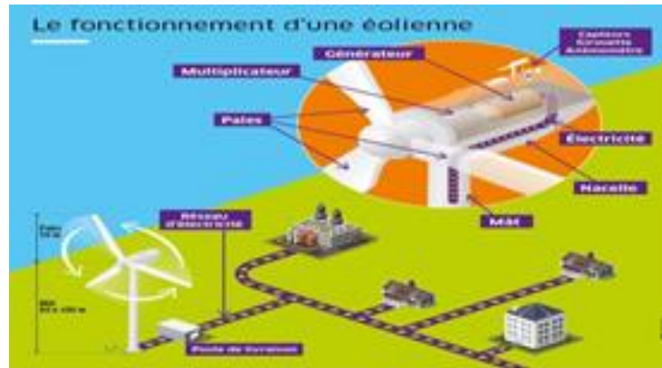
Fig III.2 le fonctionnement d'une éolienne [14]
