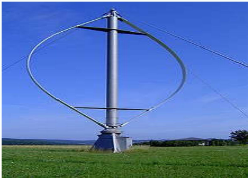
figure(I-12) : L'éolienne de Darrius[6]
