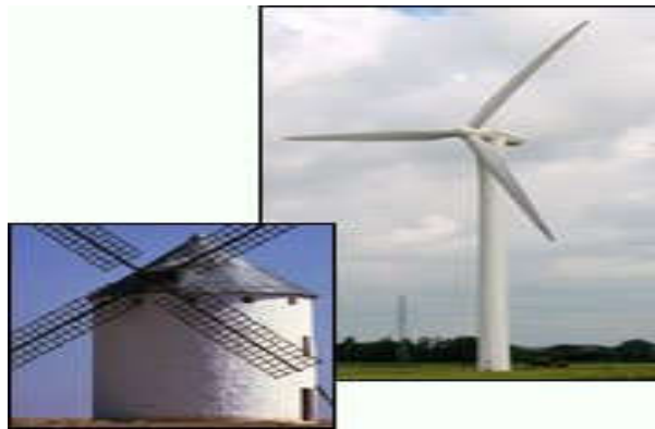
figure (I-13): Photographie d'une éolienne à axe horizontal et d'un moulin à vent [22] (Source : http://www.diebreinstoffzelle.de/alternativen/wind/index.shtml )
