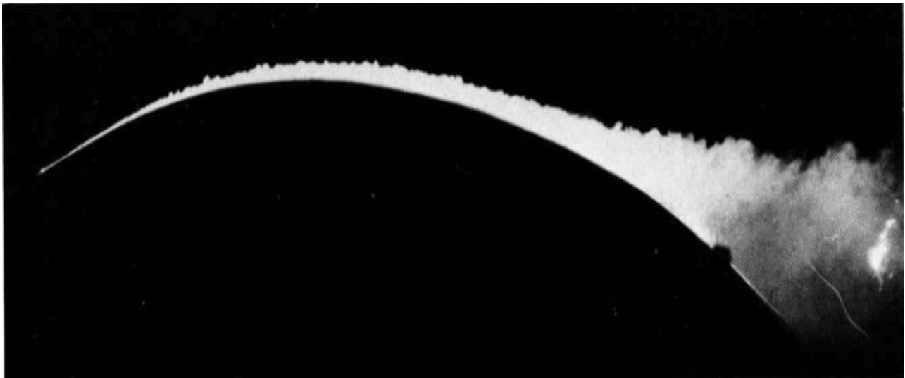
Figure. I.6: Décollement turbulent de la couche limite [9].
