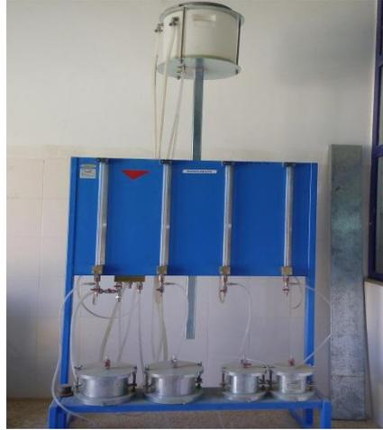
**Figure (22):** appareil de mesure de perméabilité
