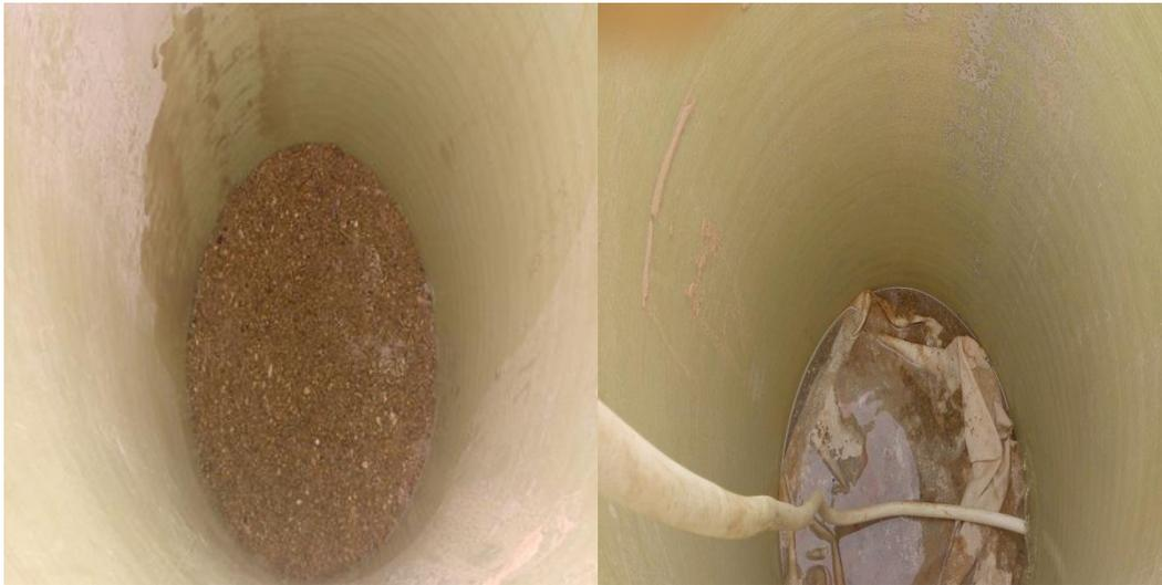
**Figure (24):** lavage de couches de sol de filtre
